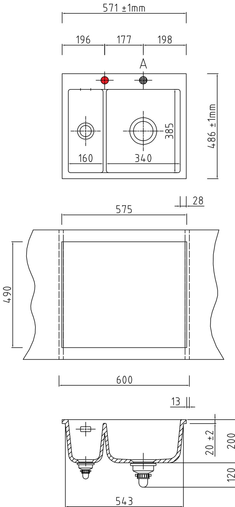
● Armaturbohrung vorhanden. Keine Sollbruchstelle.
