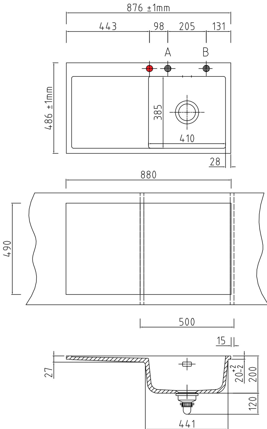
● Armaturbohrung vorhanden. Keine Sollbruchstellen. Bohrungen nach individueller Anordnung (● Pos. A und B, siehe Zeichnung).
