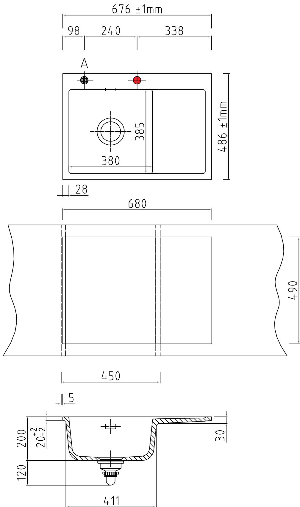
● Armaturbohrung vorhanden. Keine Sollbruchstelle.
