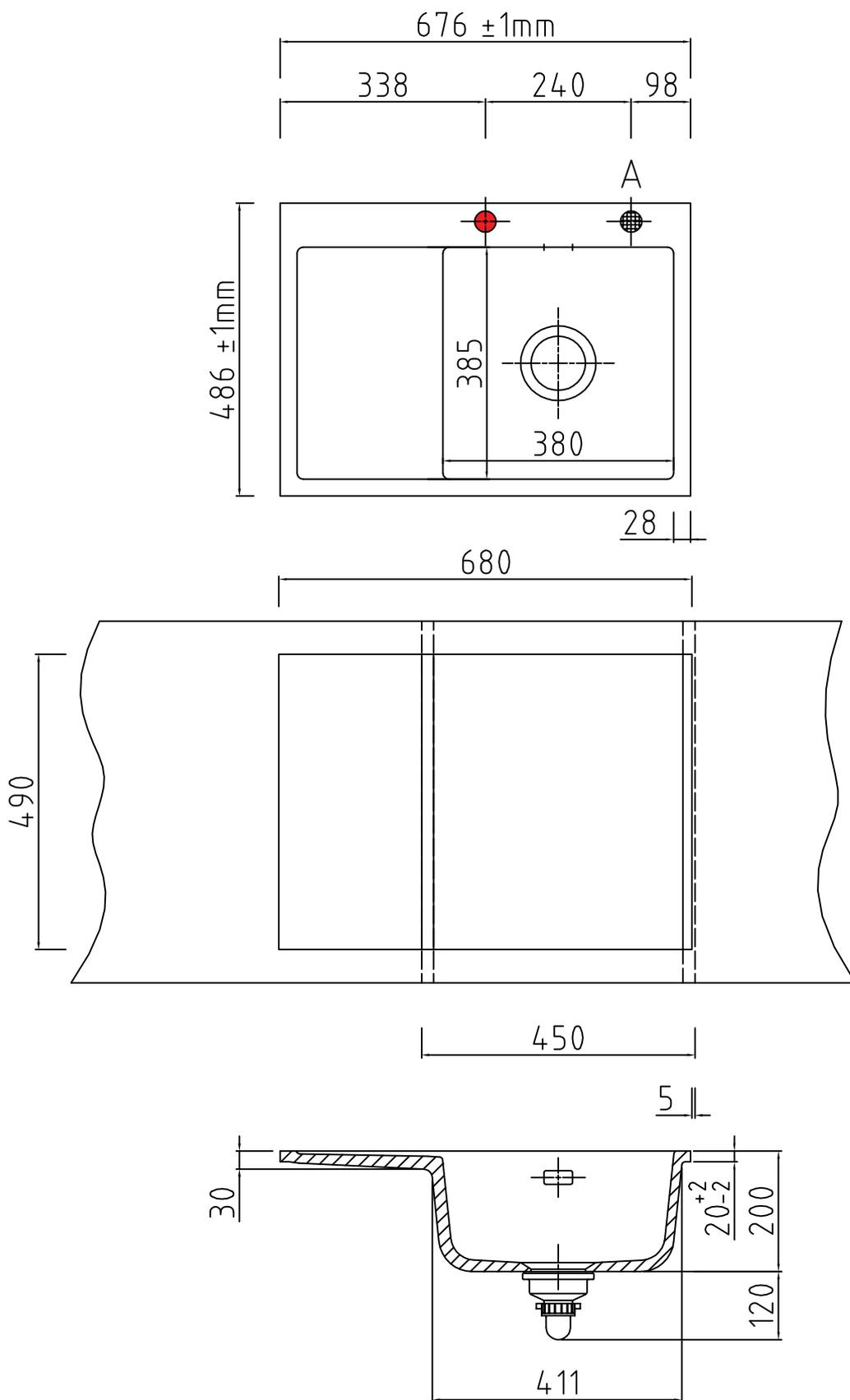
● Armaturbohrung vorhanden. Keine Sollbruchstelle.
