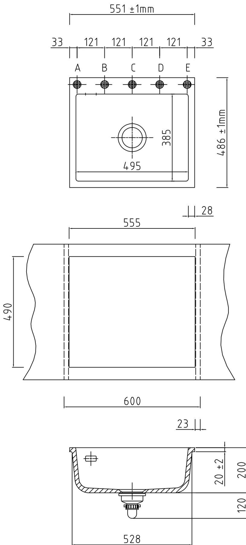
Keine Armaturbohrung vorhanden. Keine Sollbruchstellen.
