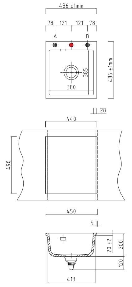
Armaturbohrung vorhanden. Keine Sollbruchstellen.
