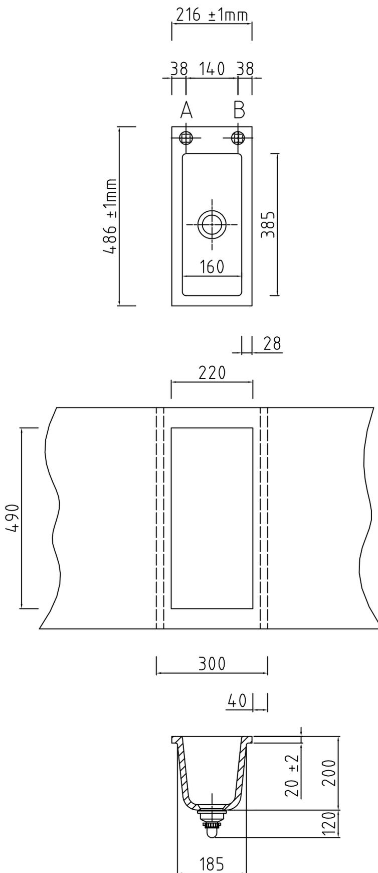
Keine Armaturbohrung vorhanden. Keine Sollbruchstellen.
