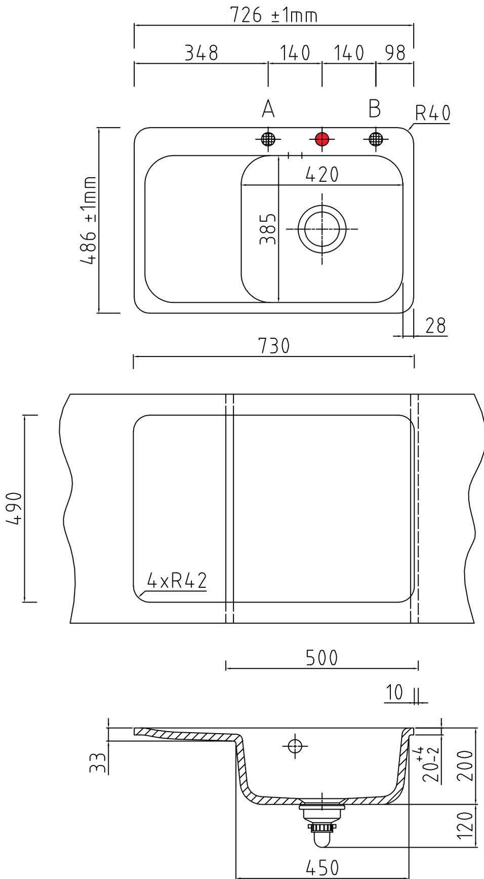
● Armaturbohrung vorhanden. Keine Sollbruchstellen. Bohrungen nach individueller Anordnung (● Pos. A und B, siehe Zeichnung).
