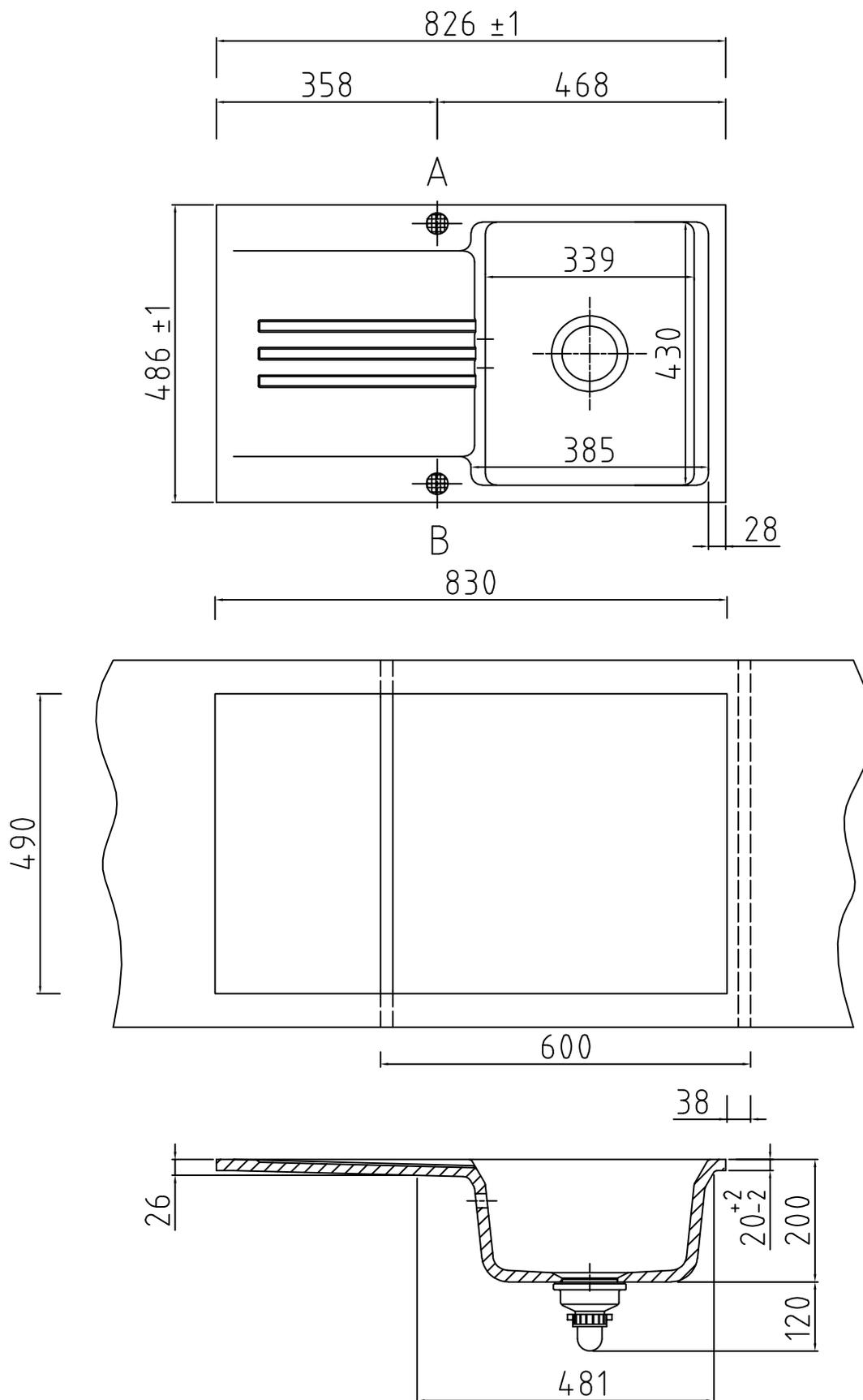
Keine Armaturbohrung vorhanden. Keine Sollbruchstellen. Bohrungen nach individueller Anordnung (● Pos. A und B, siehe Zeichnung).
