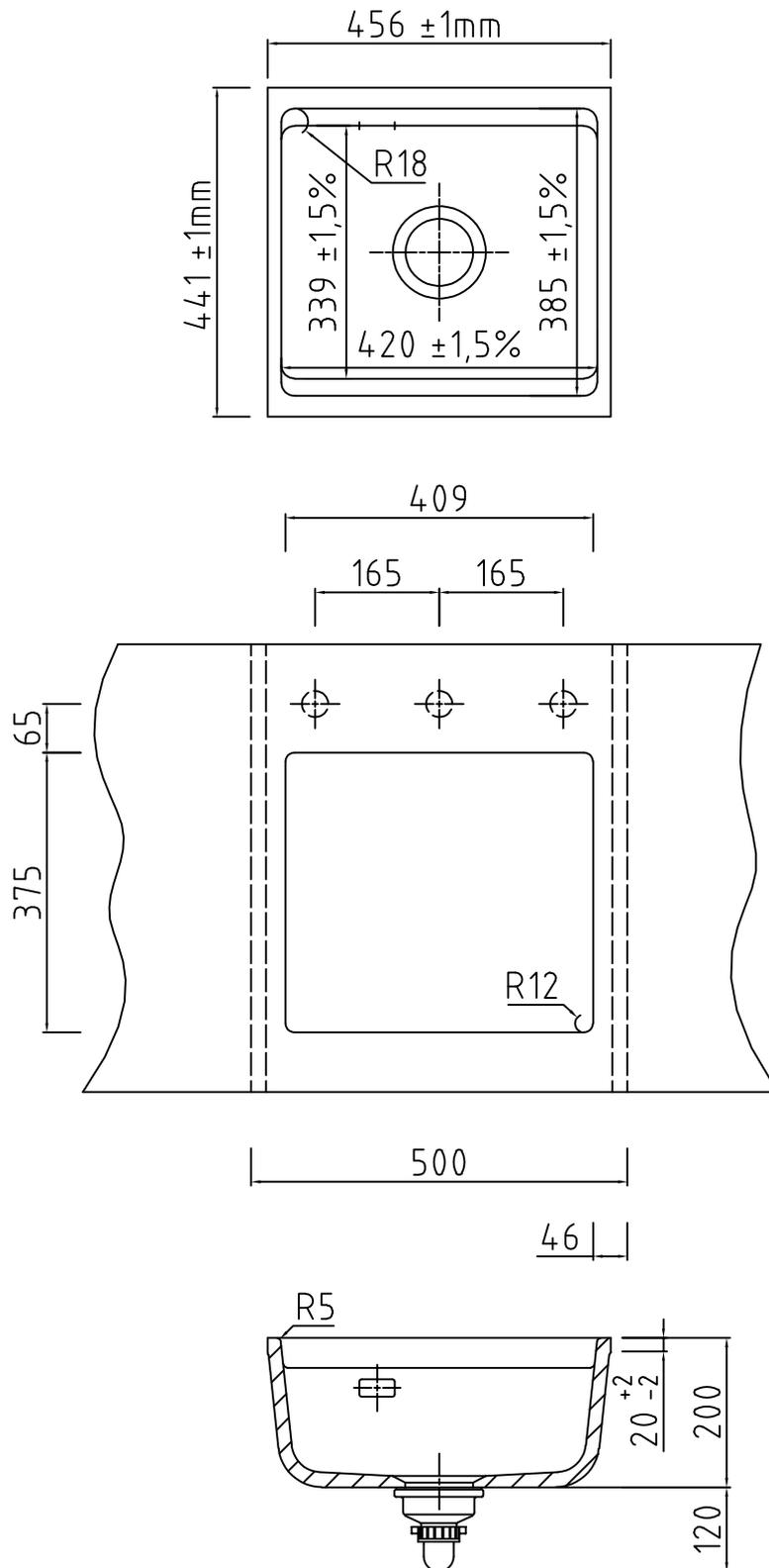
Wir empfehlen, aufgrund der werkstoffbedingten Toleranzen von  $\pm 1,5\%$  den Ausschnitt anhand des gelieferten Beckens zu fertigen.
