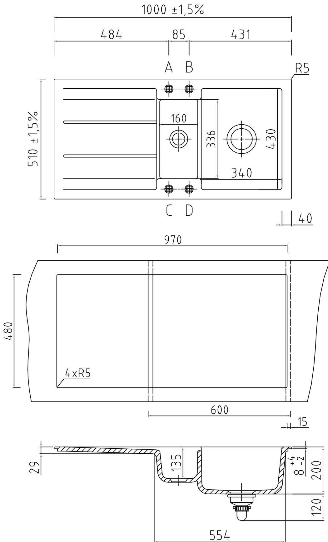
Keine Armaturbohrung vorhanden. Keine Sollbruchstellen. Bohrungen nach individueller Anordnung (● Pos. A, B, C und D, siehe Zeichnung).
