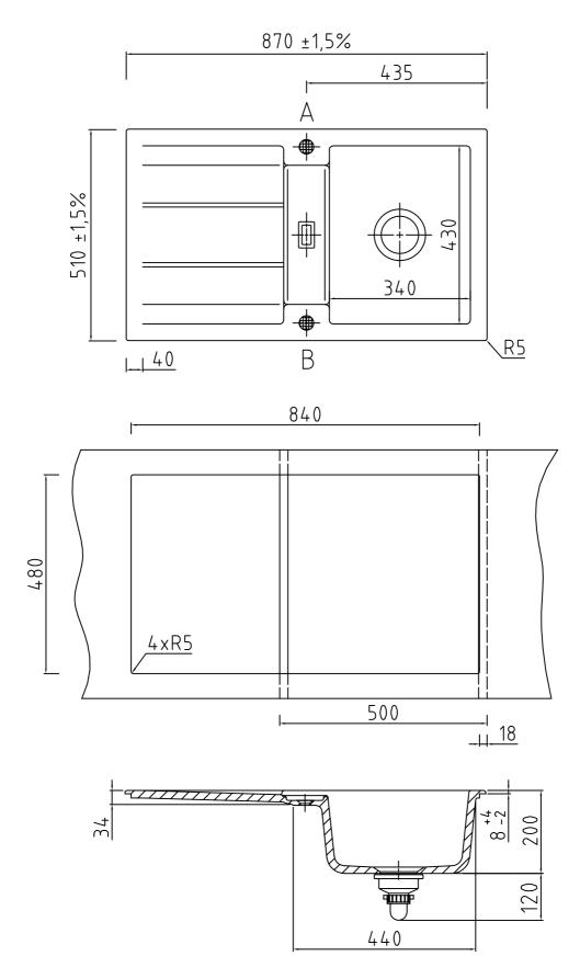
Keine Armaturbohrung vorhanden. Keine Sollbruchstellen. Bohrungen nach individueller Anordnung (
