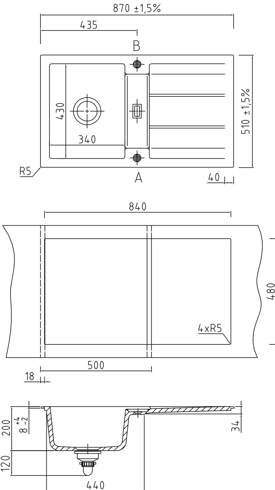
Keine Armaturbohrung vorhanden. Keine Sollbruchstellen. Bohrungen nach individueller Anordnung (● Pos. A und B, siehe Zeichnung).
