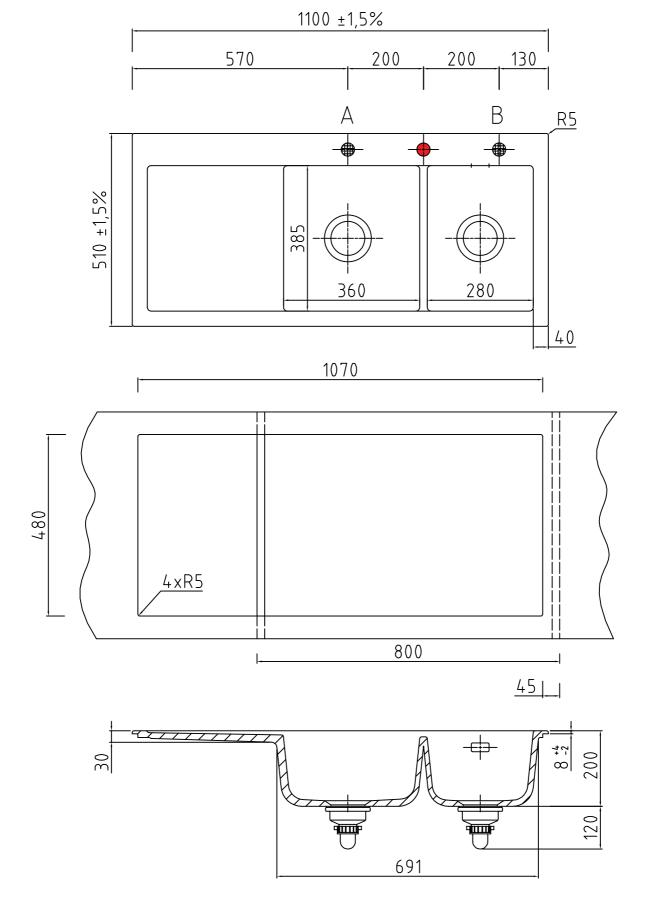
● Armaturbohrung vorhanden. Keine Sollbruchstellen. Bohrungen nach individueller Anordnung ( ● Pos. A und B, siehe Zeicnnung).
