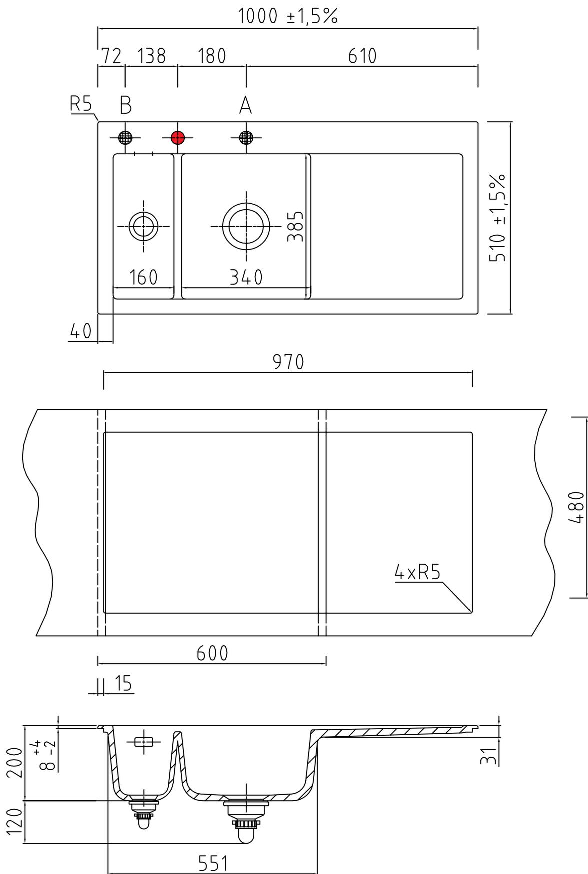
● Armaturbohrung vorhanden. Keine Sollbruchstellen. Bohrungen nach individueller Anordnung (● Pos. A und B, siehe Zeichnung).
