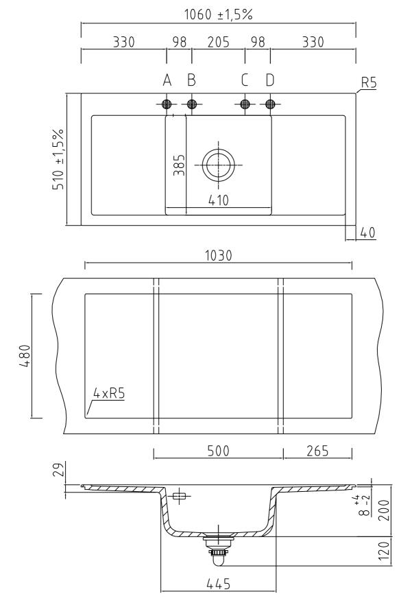
Keine Armaturbohrung und keine Sollbruchstellen. Bohrungen nach individueller Anordnung (• Pos. A, B, C und D, siehe Zeichnung).
