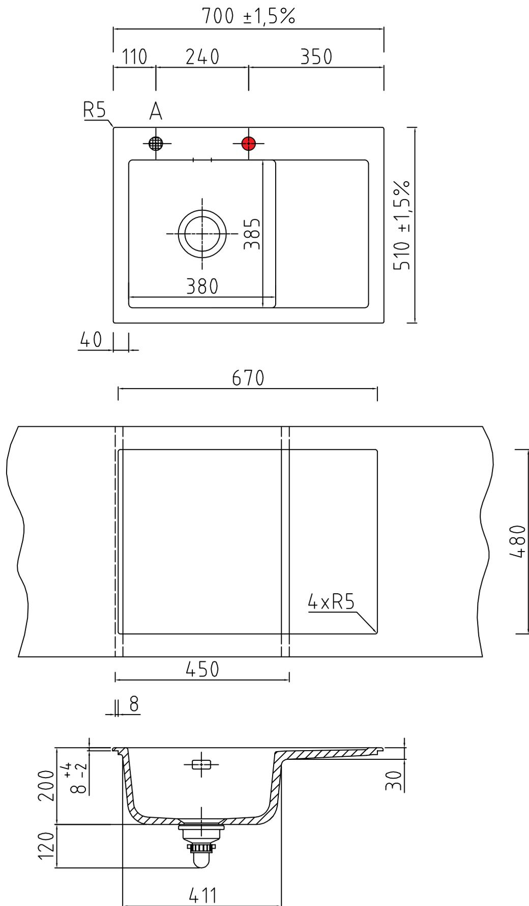
● Armaturbohrung vorhanden. Keine Sollbruchstelle.
