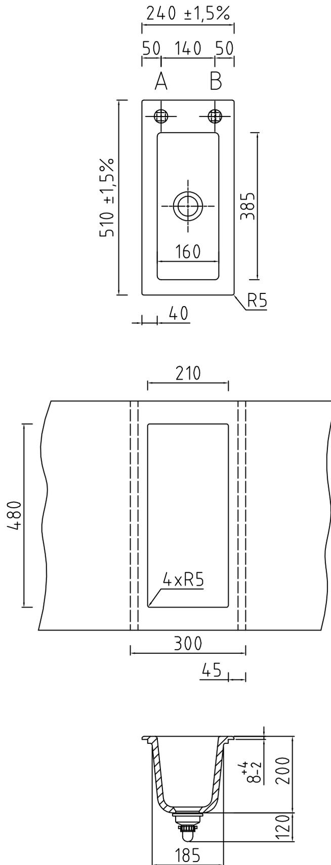
Keine Armaturbohrung vorhanden. Keine Sollbruchstellen.
