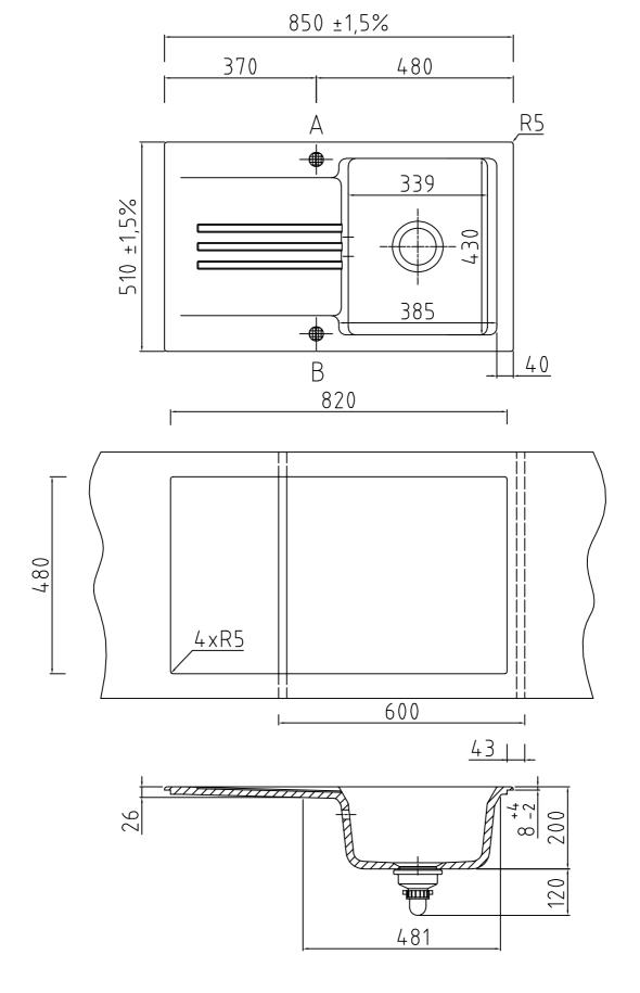
Keine Armaturbohrung vorhanden. Keine Sollbruchstellen. Bohrungen nach individueller Anordnung (
