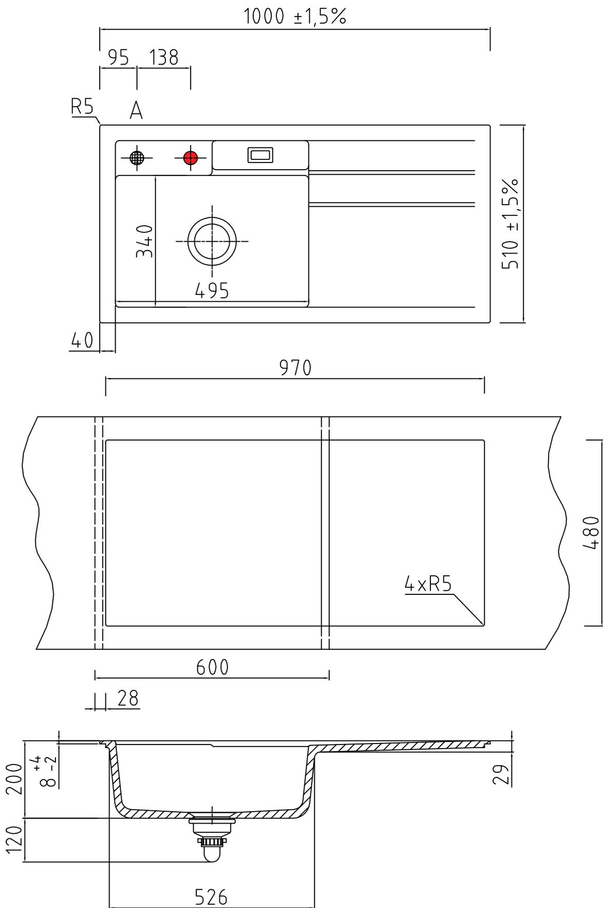
● Armaturbohrung vorhanden. Keine Sollbruchstellen. Bohrungen nach individueller Anordnung (● Pos. A, siehe Zeichnung).
