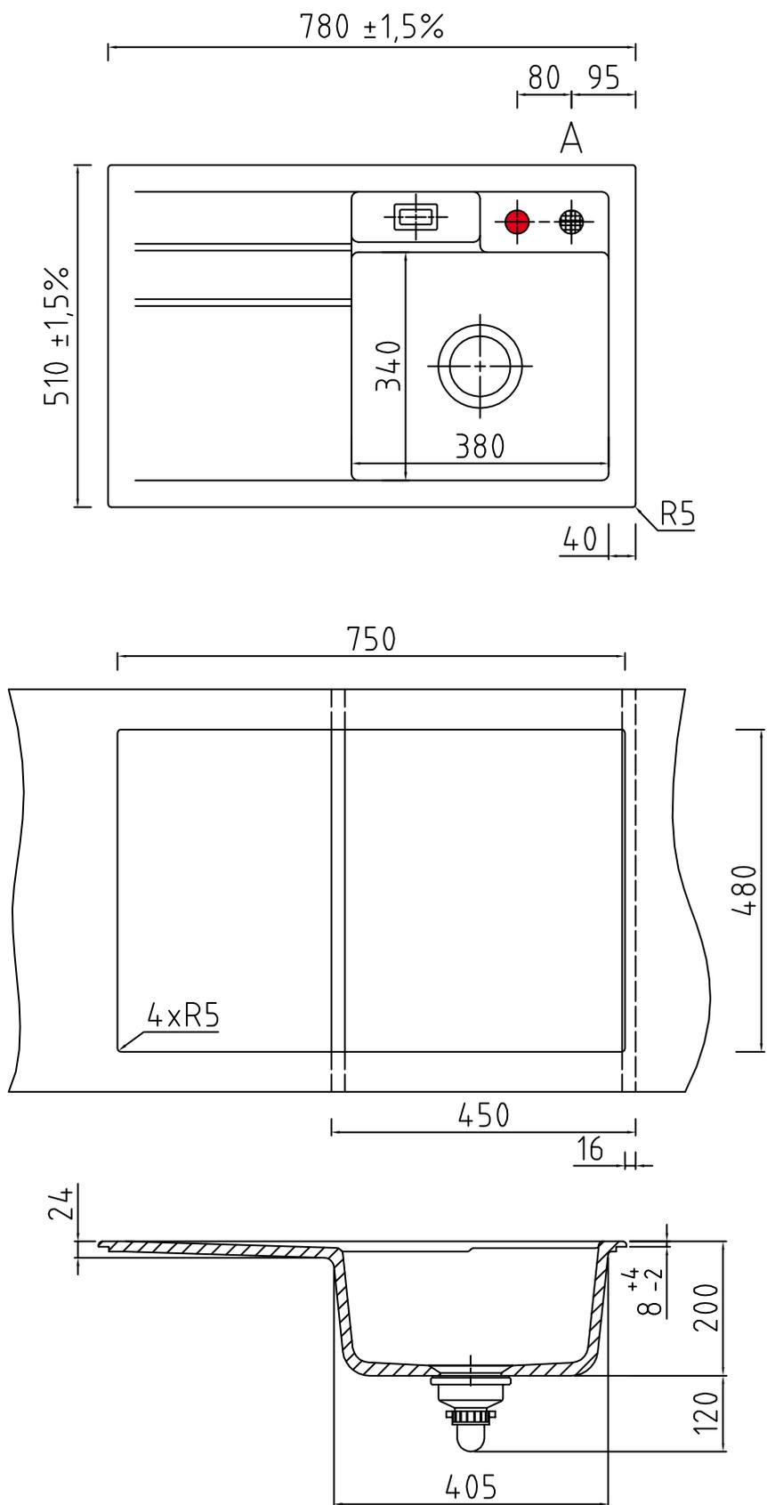
● Armaturbohrung vorhanden. Keine Sollbruchstellen. Bohrungen nach individueller Anordnung ( ● Pos. A siehe Zeichnung). Durchmesser ca. 35mm.
